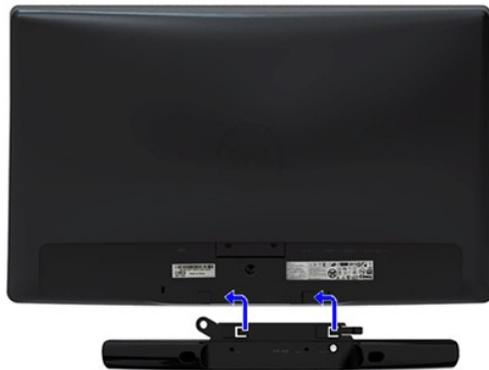
1. 在显示器的背面，通过将两个插槽与显示器底部的两个弹片对齐来连接 Soundbar。
